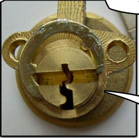
REINSTALL THE CIRCLIP AND YOU ARE COMPLETE!
